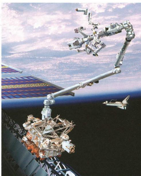
C'est ainsi qu'en 1973 prend forme le projet qui mènera à l'une des plus célèbres inventions canadiennes: construire le premier télémanipulateur pour la navette spatiale *Columbia*. Le bras robotisé sera conçu pour exécuter des tâches complexes sur orbite, comme le déploiement et le retrait de satellites. [...]
